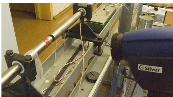
Рис. 2. Разрезной стержень Гопкинсона–Кольского с установленной инфракрасной камерой
