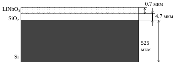
Рис. 3. Структура подложки тонкоплёночного ниобата лития до протонного обмена
