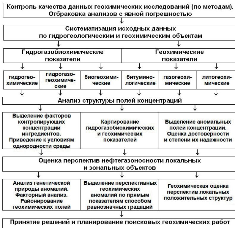
Рис. 1. Функциональная схема обработки данных прогнозно-рекогносцировочных геохимических исследований
