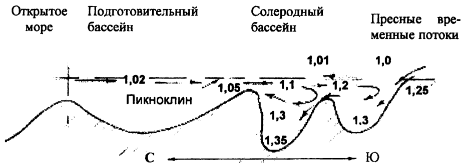
Рис. 1. Модель (продольный разрез) Верхнекамского соленодного бассейна (по данным В.М. Ковалевича, Р.Ф. Шмальца, В.И. Копнина). Цифры – плотность, г/см 3
