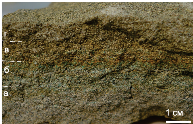
Рис. 5. Строение меденосной коры выветривания: а – неизменный песчаник с кальцитовым поровым цементом и рассеянной вкрапленностью малахита; б – песчаник с малахитовым цементом; в – песчаник с охристыми гидроксидами железа в выщелоченных порах; г – песчаник с выщелоченным кальцитовым цементом
