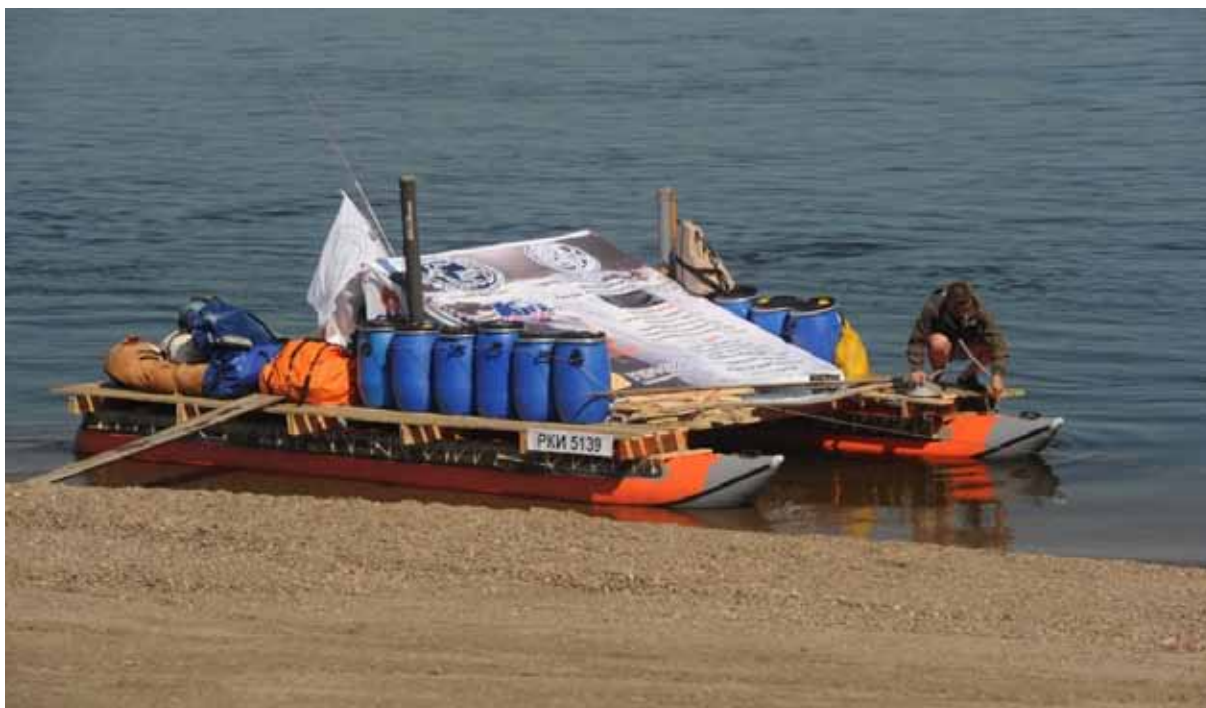
Рис. 1. Катамаран с усиленной рамой, навесом и мотором на 15 л.с (фото автора)
