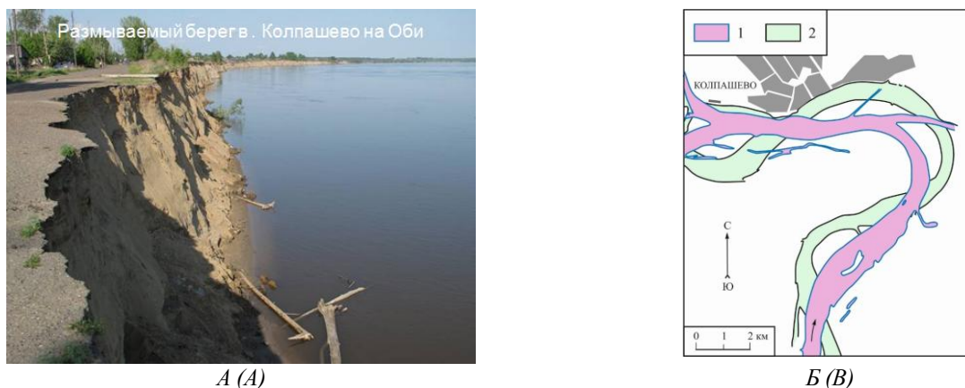
Рис. 1. Переформирования русла р. Оби, создающие опасность для г. Колпашево: А – размываемый берег; Б – изменения русла по мере размыва вогнутого берега и смещения излучины. Положения русла: 1 – в 1910 г.; 2 – в 2010 г. [4, с изменениями] Fig. 1. Reshaping of the Ob riverbed, which creates danger to Kolpashevo. А – eroded bank; Б – changes in the channel as the concave bank erodes and the bend shifts. The riverbed position: 1 – in 1910; 2 – in 2010 [4, with changes]
