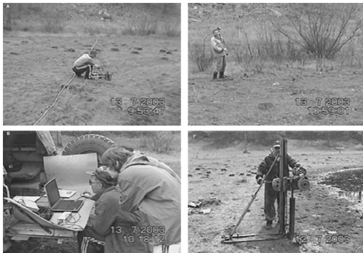
Рис. 2. Геофизическое и буровое оборудование для изучения стратиграфии приповерхностных рыхлых отложений: а – кося с сейсмографами (пункты приема); б – источник возбуждения волны ударного типа; в – регистрация сейсмосигнала; г – буровая установка УКБ-12/25
