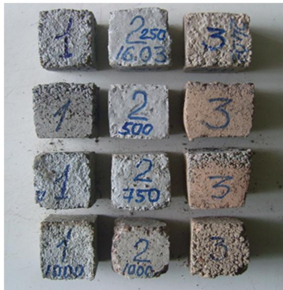
Рис. 5. Образцы, подвергшиеся нагреванию до 250, 500, 750 и 1000°C
