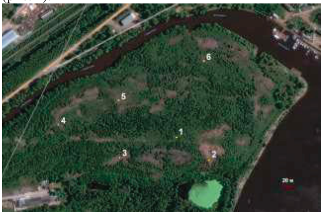
Рис. 1. Краснокамский короотвал: точки бурения скважин и отбора материала КДО
