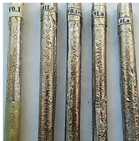
Рис. 1. Образцы из алюминиевого проводникового сплава AlV0.1, легированного лантаном
