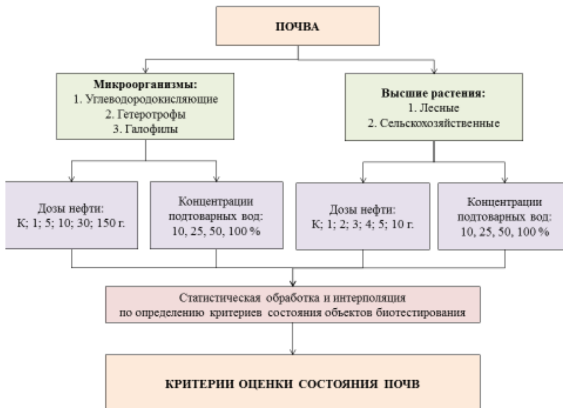
Рис. 5. Схема биотестирования почв, загрязненных нефтью и подтоварными водами
