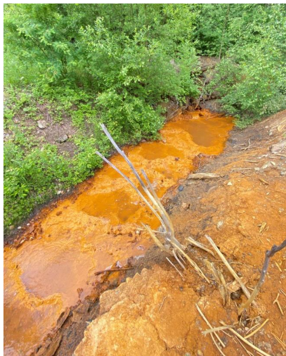
Рис. 1. Техногенный осадок в местах выхода шахтных вод
