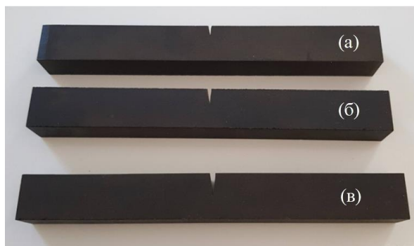
Рис. 3. Образцы из эбонита с разной глубиной V-образного надреза: а) глубиной 5 мм; б) глубиной 7.5 мм; в) глубиной 10 мм
