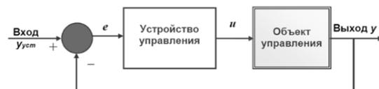
Рис. 2. Структура системы автоматического управления
