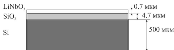
Рис. 4. Схематическое изображение поперечного сечения пластины тонкопленочного НЛ
