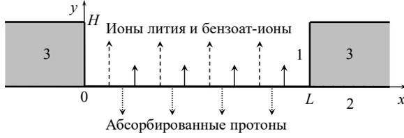
**Рис. 1.** Геометрия задачи и система координат: 1 – расплав бензойной кислоты, 2 – кристалл ниобата лития, 3 – фотолитографическая маска
