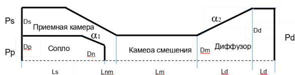
Рис. 1. Схема струйного насоса, его основные геометрические размеры и граничные условия
