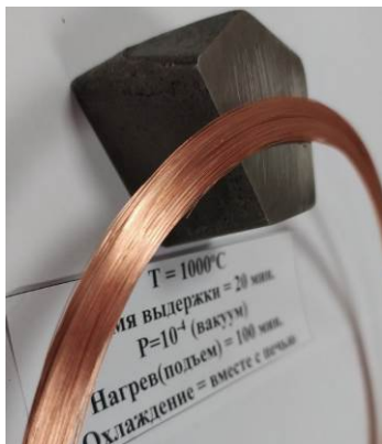
Рис. 5. Внешний вид свободной намотки оптического волокна с медным покрытием после термообработки на 1000\text{ }^{\circ}\text{C}
