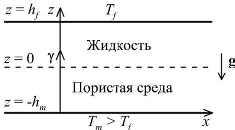
Рис. 1. Двухслойная система, подогреваемая снизу в поле силы тяжести
