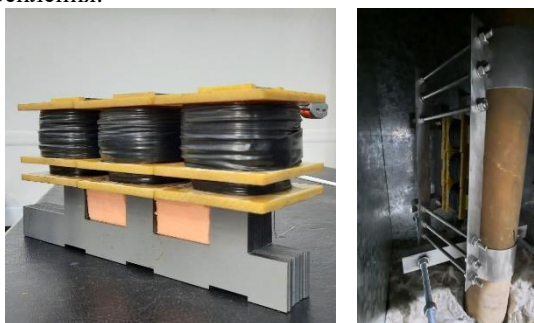
Рис. 3. Фотографии общего вида НИСИС в линейном исполнении (слева) и его сборки на испытательный стенд (справа)
