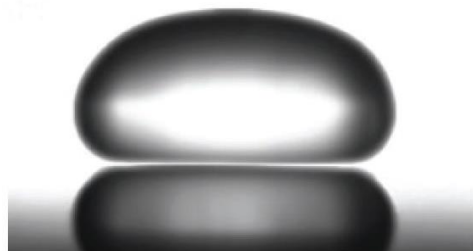
Рис. 1. Экспериментальная фотография левитирующей капли; взята из обзорной работы [4]. Согласно описанию капля находится в подвешенном состоянии над металлической пластиной при температуре T = 300^\circ\text{C}
