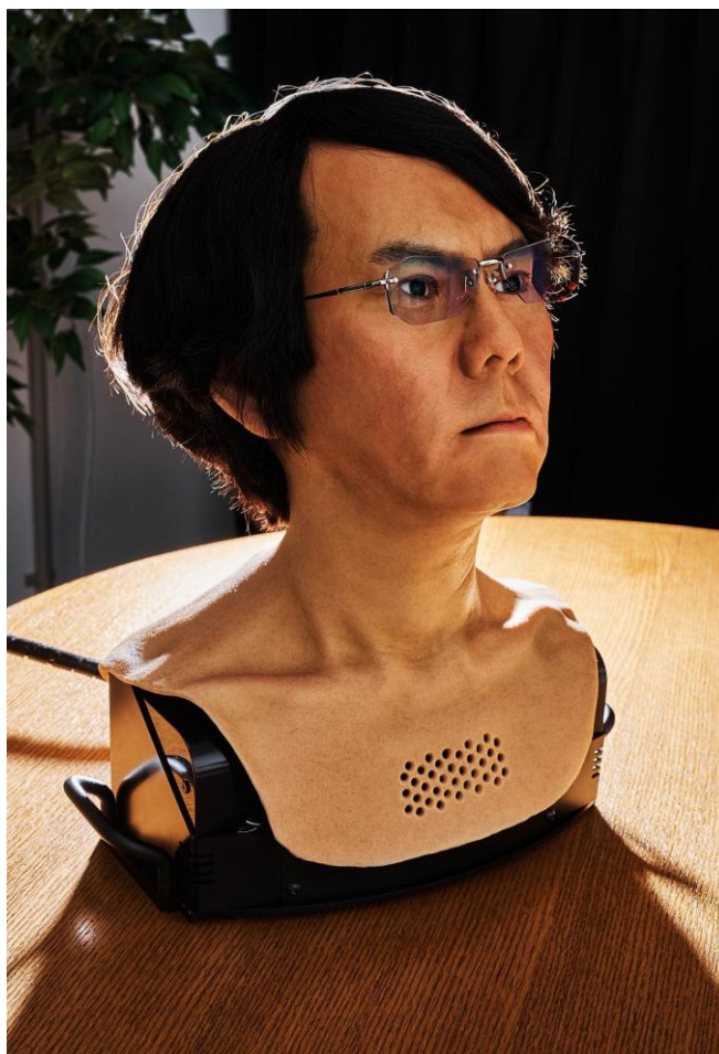
Рис. 2. Геминоид HI-2 (2009): робот является точной копией профессора Хироси Исигуро, имеет 50 степеней свободы в реакциях поведения, что делает его очень похожим на реального человека.
