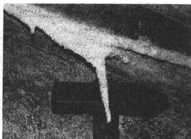
Рис. 6. Шлиф кальцитового сталактита с моста через р. Нерль. "Волосовидный" агрегат, вероятно обрастание кальцитом гифа гриба или водоросли, прозрачный шлиф (николи X, длина 1 мм)
