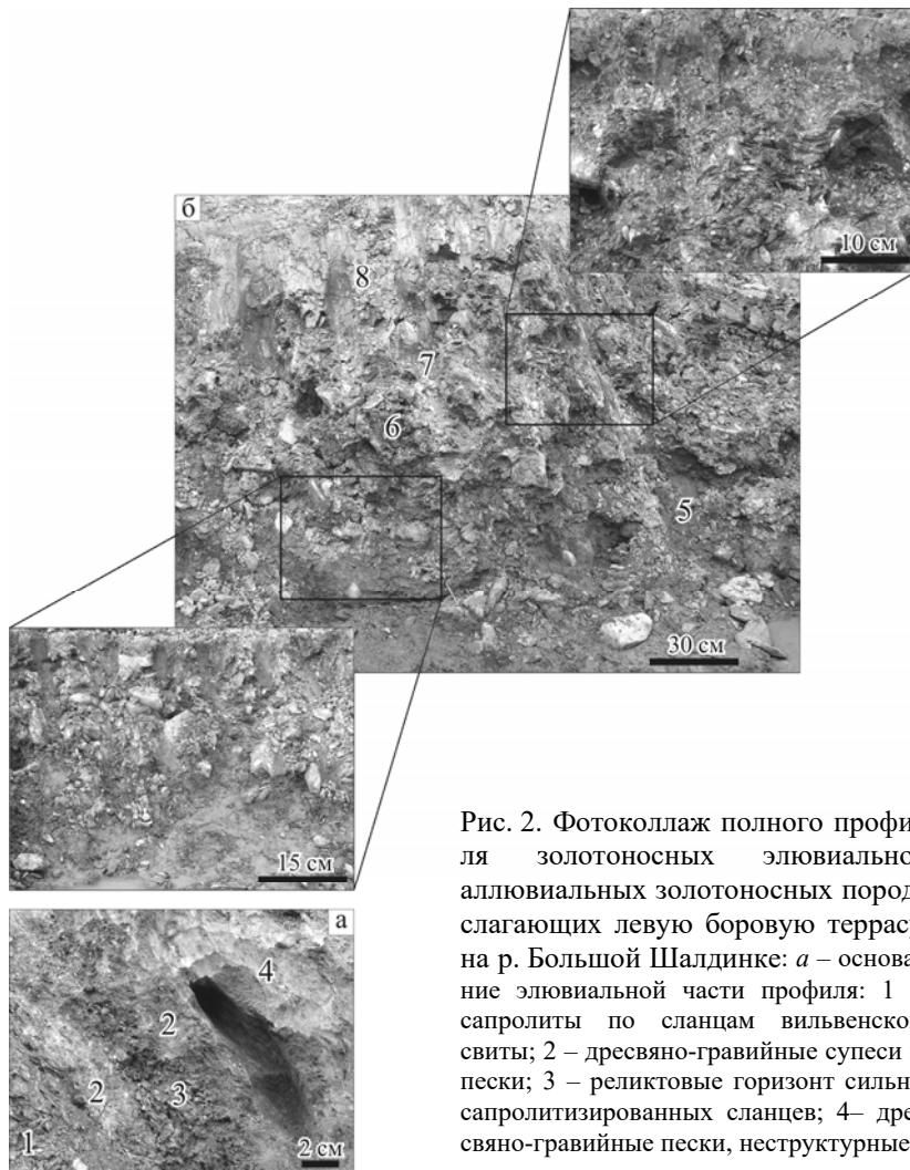
Рис. 2. Фотоколлаж полного профиля золотоносных элювиально-аллювиальных золотоносных пород, слагающих левую боровую террасу на р. Большой Шалдинке: а – основание элювиальной части профиля; 1 – сапролиты по сланцам вильвенской свиты; 2 – дресвяно-гравийные супеси и пески; 3 – реликтовые горизонты сильно сапролитизированных сланцев; 4 – дресвяно-гравийные пески, неструктурные.
