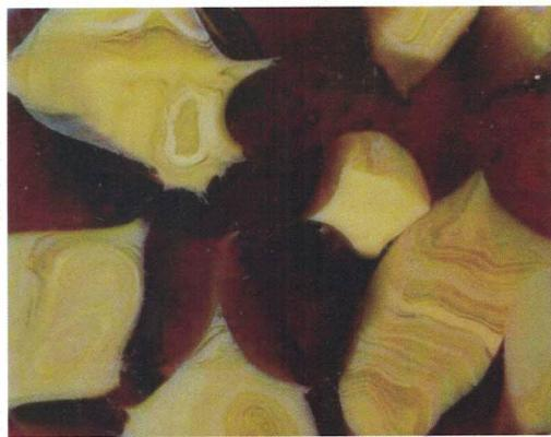
Рис. 4. Обломки бежевого агатового глущеного стекла в матрице коричневого прозрачного стекла (брекчиевая текстура).
