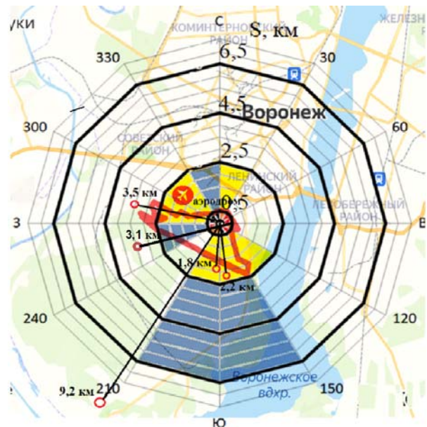
Рис. Диаграмма прогнозируемого ареала загрязнения почв свинцом и карта с контрольными точками
