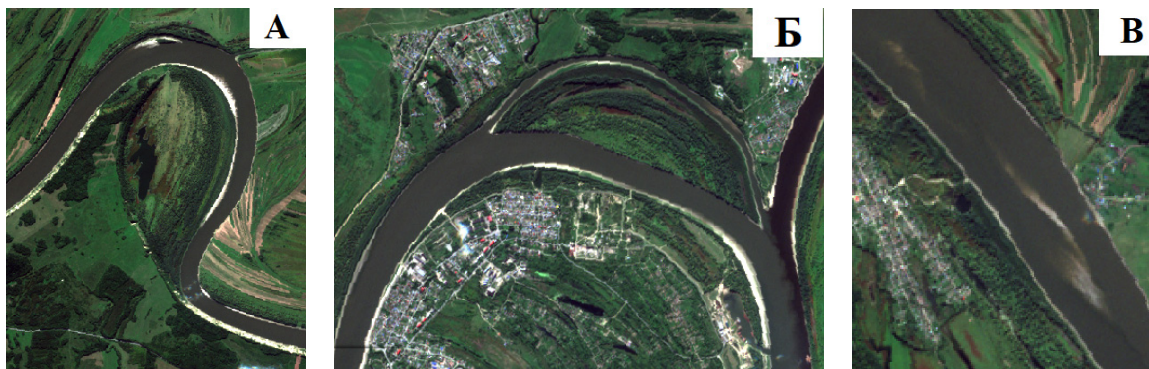
Рис. 10. Типы русла в морфологически однородном участке X (696–664 км): А – свободная и вынужденная излучины; Б – большая сегментная излучина с разветвлением в привершинной части (о. Бизинский); В – прямолинейное русло с осередковыми разветвлениями
