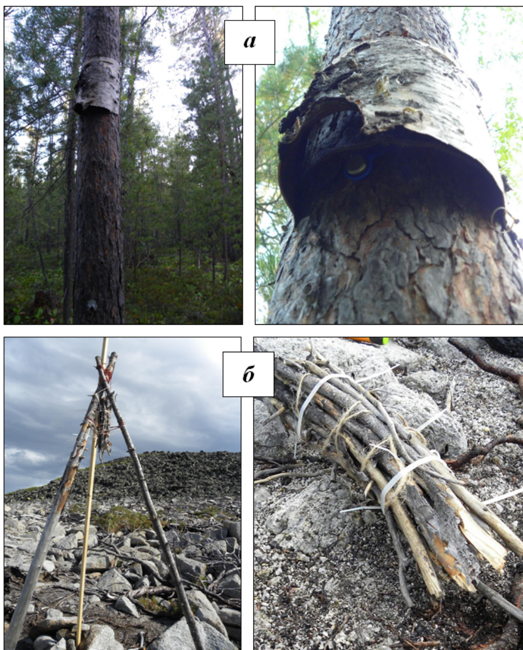
Рис. 2. Установка термографа Thermochron iButton DS1925L-F5: a – в горнотаежном поясе (1039 м над у.м.) и б – подгольцовом поясе (1280 м) Fig. 2. Installation of Thermochron iButton DS1925L-F5 thermograph in a ) mountain taiga belt (1039 m above sea level) and b ) podgoltsovyi belt (1280 m)
