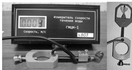
Рис. 4. Гидрометрическая микровертушка ГМЦМ-1 (ЗАО НПО «Межрегион-золото», г.Элиста) (по [17; 20])
