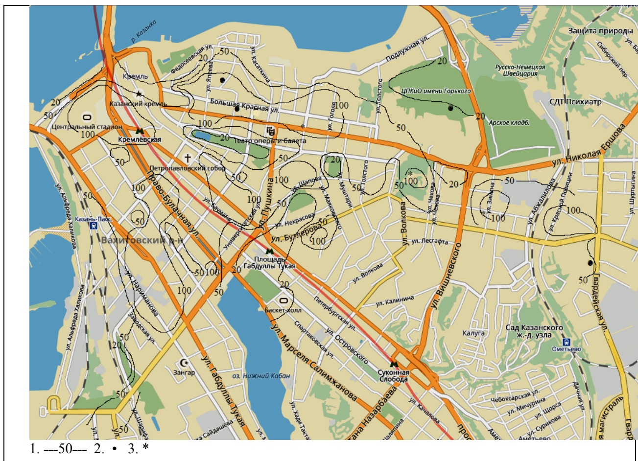
Рис. 2. Схематическая карта значений магнитной индукции в центральной части г. Казани: 1 – изолинии и их оцифровка, нТл; 2 – аномалии по 3δ пределу; 3 – аномалии по 2δ пределу
